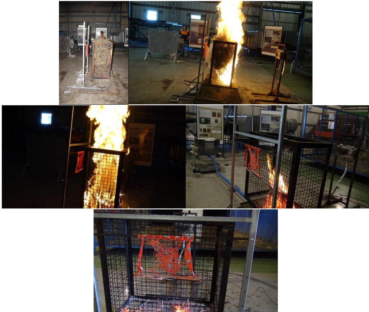
*Figura 5 – No ensaio GO 4, a distância da gola ao cesto foi de 0.2m, como se pode ver nas duas primeiras imagens. No final do ensaio a gola estava muito perfurada, embora não se tenha inflamado.*
