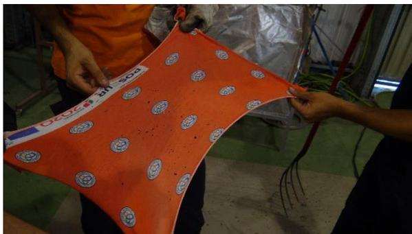
*Figura 7 – Sujeitando a gola ao impacto de partículas incandescentes, verificou-se que esta era perfurada pelas partículas, mas não entrava em combustão.*
