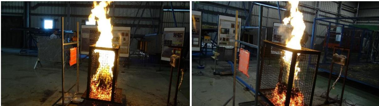
*Figura 3 – No ensaio GO 2, a distância da gola ao cesto foi de 0.5m. No final a gola estava praticamente intacta, mas optou-se por utilizar uma nova peça no ensaio seguinte.*
