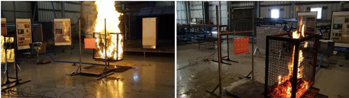
*Figura 2 – No ensaio GO 1 distância da gola ao cesto foi de 1.0m. No final do ensaio a gola estava praticamente intacta e por isso foi utilizada no ensaio seguinte.*
